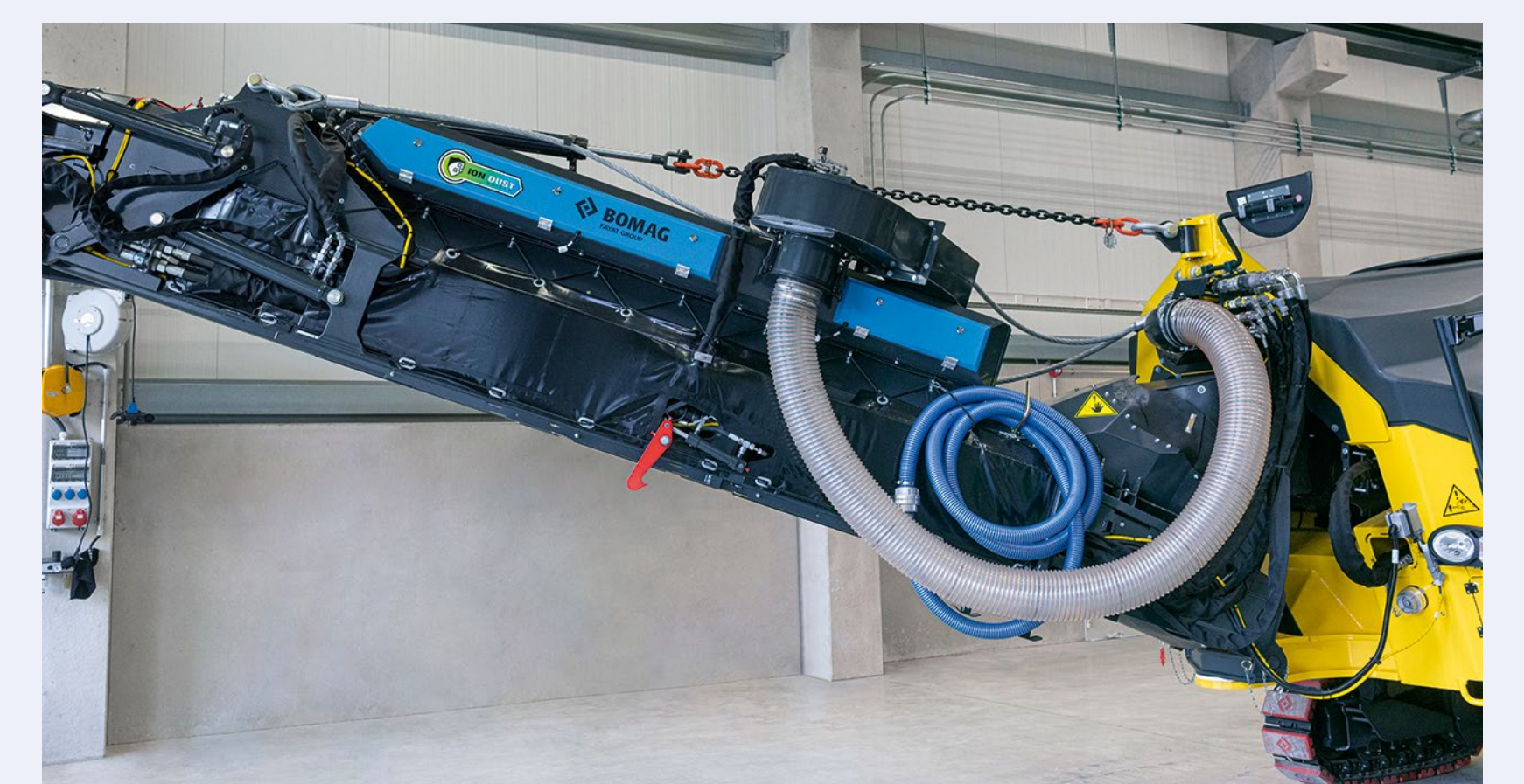
Das ION DUST SHIELD der BOMAG GmbH trägt zur Reduzierung der Luftverschmutzung durch Feinstaub bei, indem der Staub direkt nach Entstehen beim Fräsprozess nicht nur abgesaugt, sondern im Gehäuse in Grobstaub umgewandelt wird. (Foto: BOMAG GmbH)
