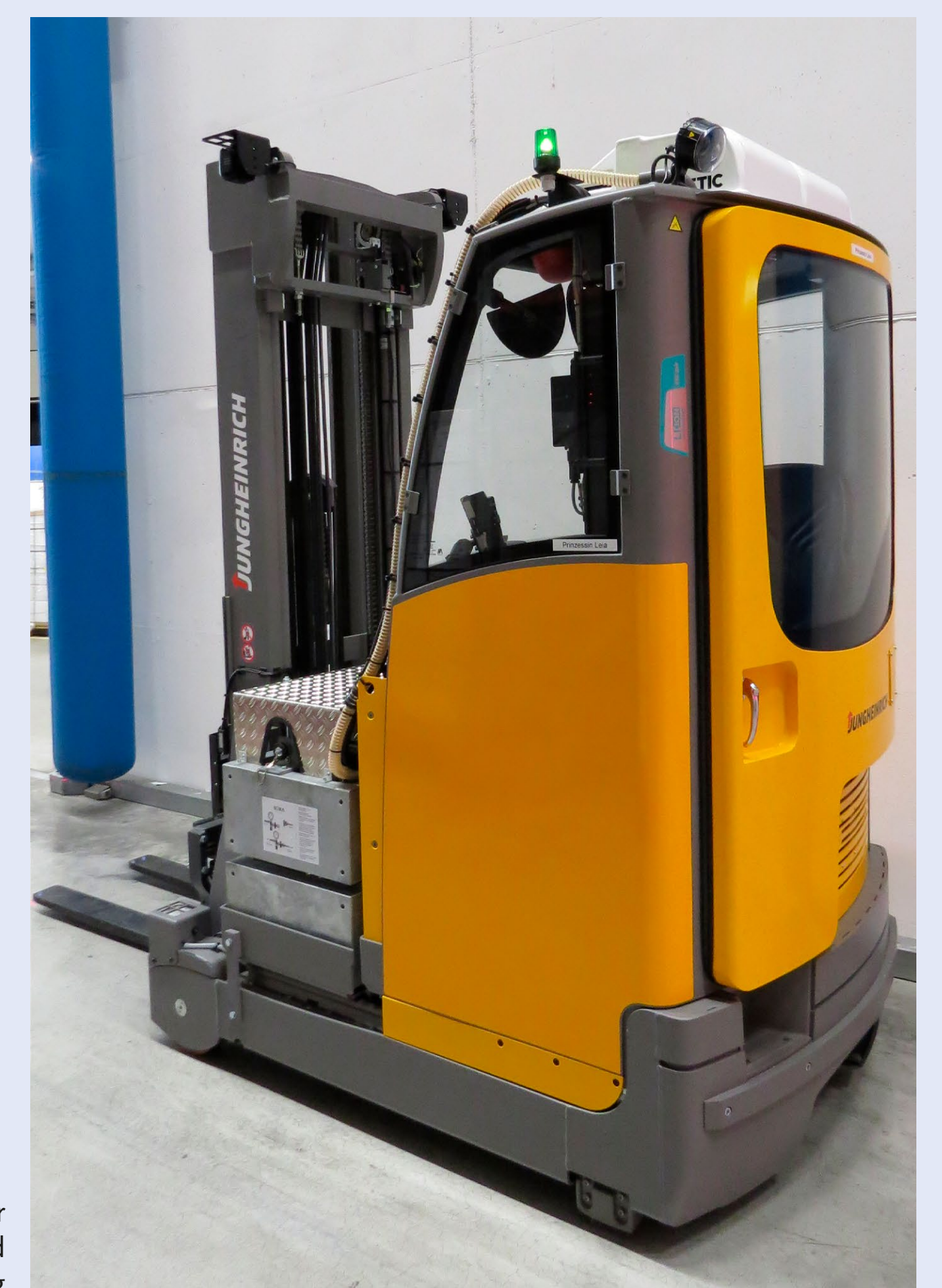
Stapler mit gasdichter Fahrerkabine und Belüftung
