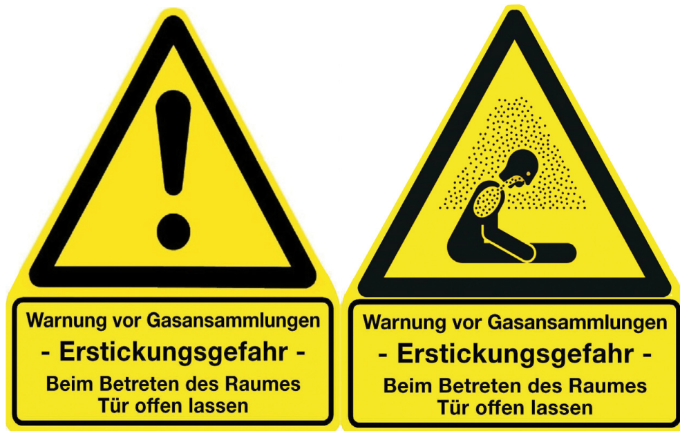
Abb. 7.3-2 Warnzeichen Wo01 oder Wo41 mit Warnung vor Erstickungsgefahr
