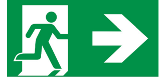
Kennzeichnung gemäß Technischer Regel für Arbeitsstätten ASR A1.3 Sicherheits- und Gesundheitskennzeichnung
