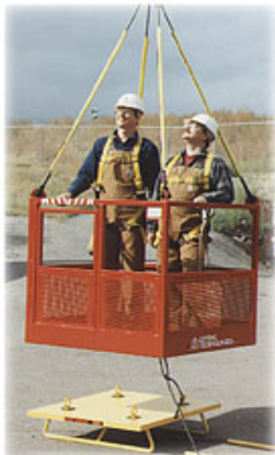
Vom Kran mittels einem Anschlagmittel (Lastaufnahmemittel) angehobene Arbeitsplattform
