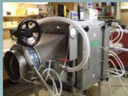
Dekontamination durch  $H_2O_2$  -Begasung für Filter in raumlufttechnischen Anlagen für Laboratorien der Schutz- und Sicherheitsstufen S3-S4
