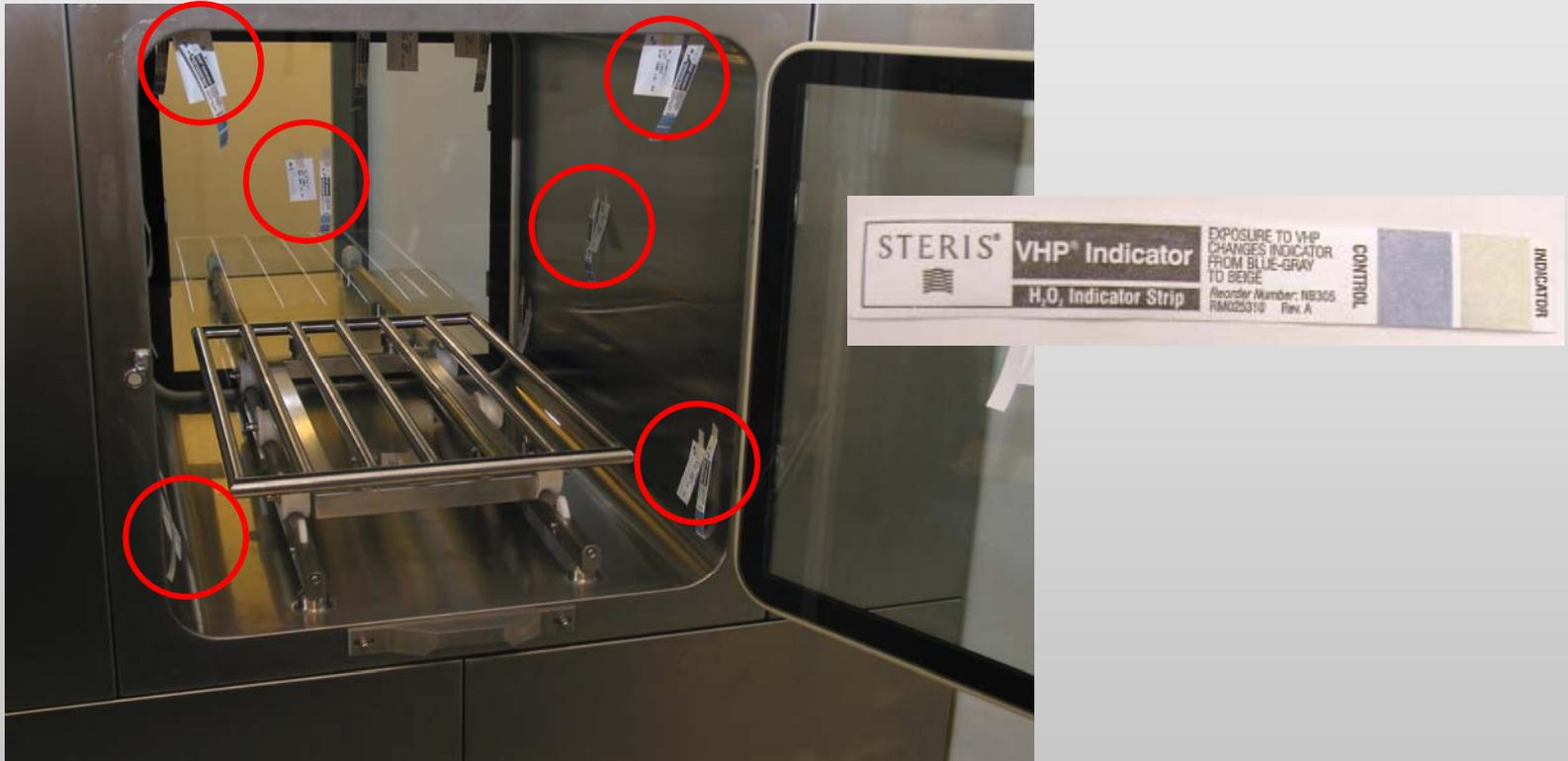
Chemischer Indikator zur Überprüfung der Gasverteilung
