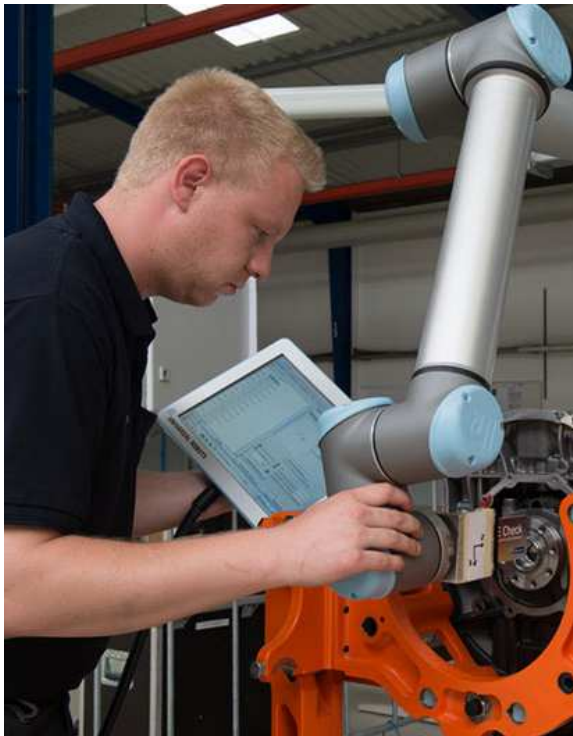
Entfernen von überschüssigem Dichtmittel
