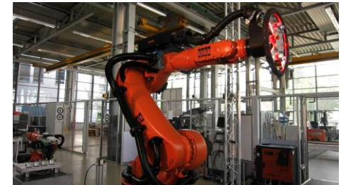
Werkerassistenz mit Industrieroboter hoher Traglasten Handgeführter Roboter/ Sicherheit/ Ergonomie
