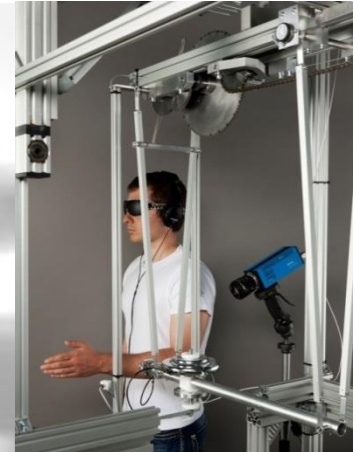
Kollisionsmesssystem des IFF für dynamische Kollision (Probandenversuche)
