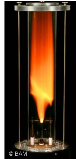
Bestimmung der Explosionsgrenzen von Ammoniak nach DIN EN 1839
