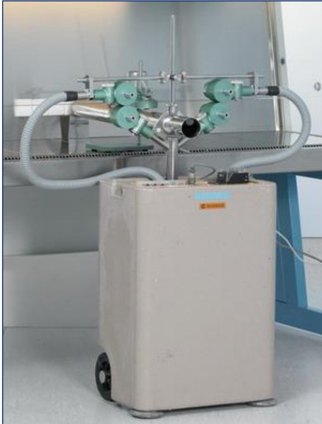
Chemische Prüfung („KI-Diskus-Test“) des Personenschutzes.
