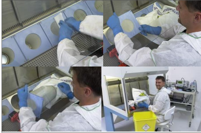
Kontaminationsarmer Filterwechsel mittels segmentierter Hauptfilterstufe
