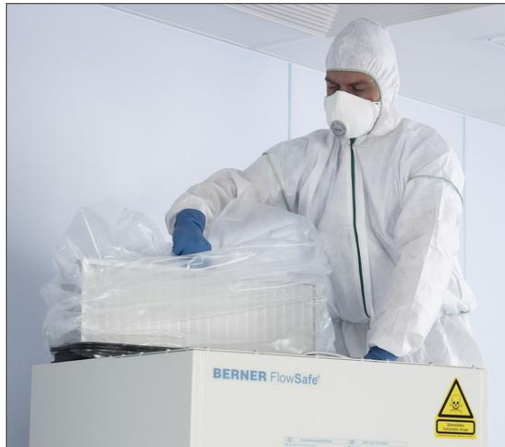
Kontaminationsarmer Filterwechsel mittels „Sackwechseltechnik“
