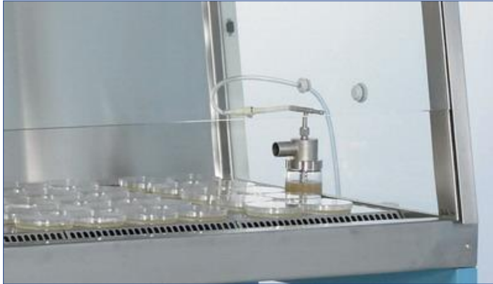
Mikrobiologische Prüfung des Verschleppungsschutzes.
