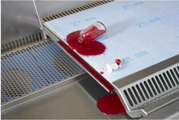
Spill-Liquid-Guard schützt die HEPA-Hauptfilter vor verschütteten Flüssigkeiten.
