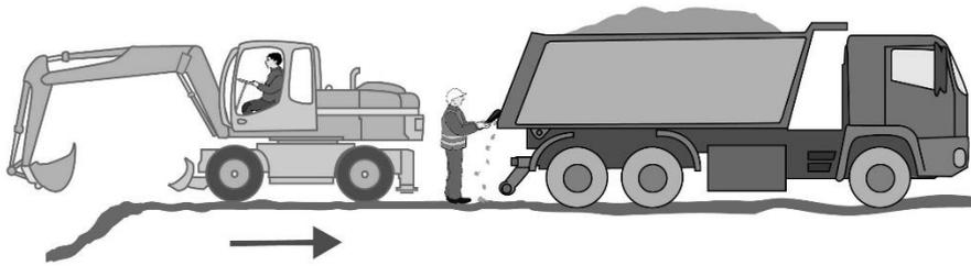
Abb. 2 Gefährdung durch Rückwärtsfahren des Baggers
