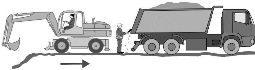
Abb. 2 Gefährdung durch Rückwärtsfahren des Baggers
