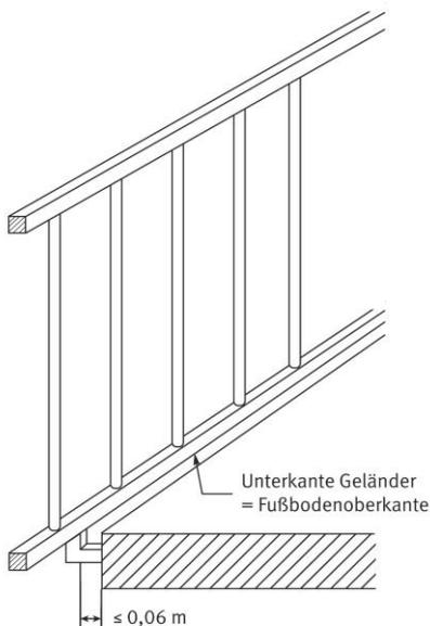
Abb. 4: Vorgesetztes Füllstabgeländer
