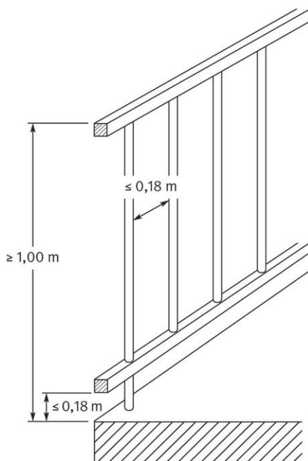
Abb. 2: Füllstabgeländer
