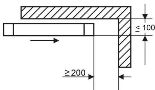
Abb. 2: Vermeiden von Quetschgefahr zum Schutz des Kopfbereiches
