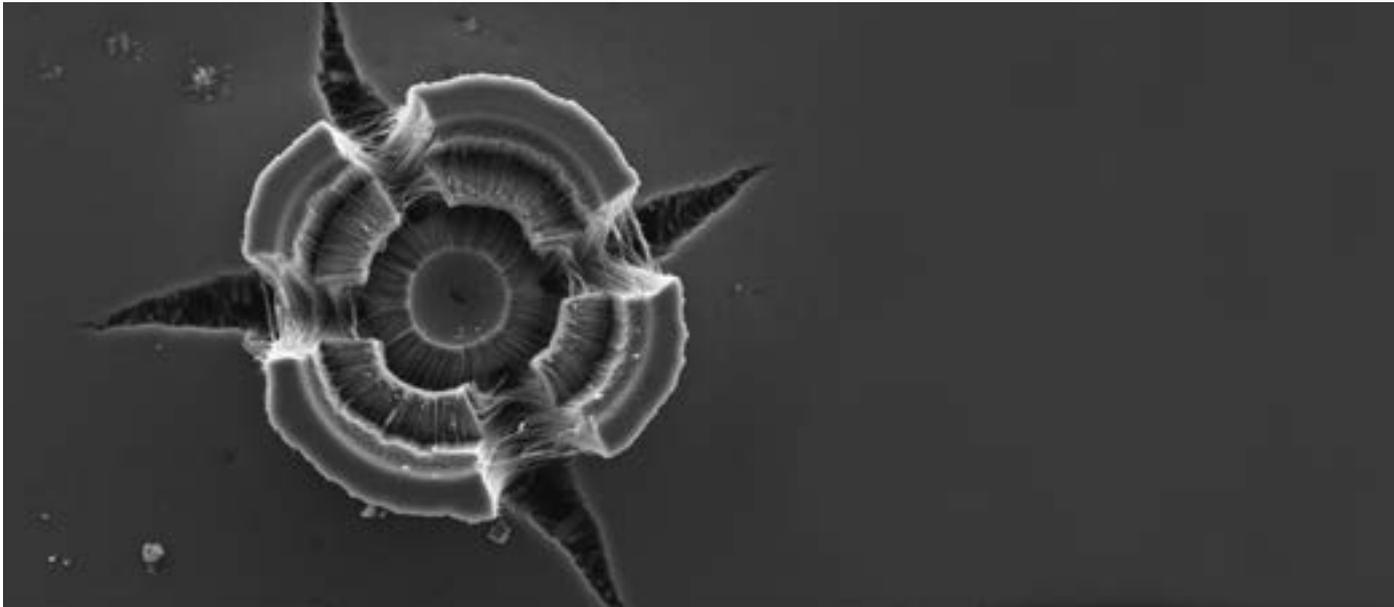
Rasterelektronenmikroskopische Aufnahme einer sternförmigen Defektstruktur aus Kohlenstoffnanoröhren. Der Stern hat sich aufgrund interner mechanischer Spannungen spontan in einem sogenannten CNT-Rasen gebildet (Durchmesser: 300 µm).
