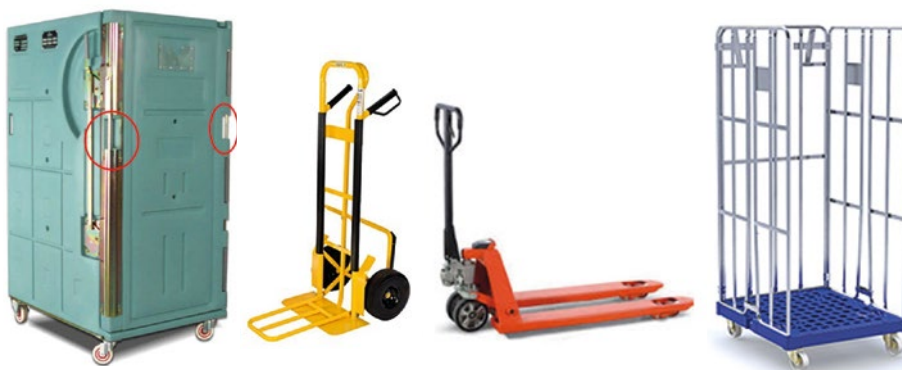
Abb. 18 Flurförderzeuge mit guter Griffgestaltung/Krafteinleitung.
