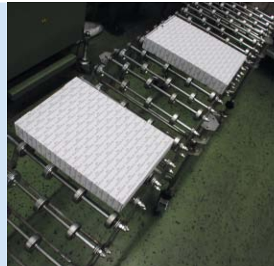
Auf Rollenbahnen und Kugeltischen können Gegenstände mit flachem Boden ohne Umsetzen leicht verschoben werden.
