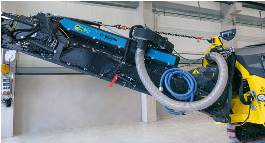
Das ION DUST SHIELD trägt zur Reduzierung der Feinstaubbelastung an Baustellen bei, indem der Staub direkt nach Entstehen beim Fräsprozess abgesaugt und im Gehäuse in Grobstaub umgewandelt wird.
