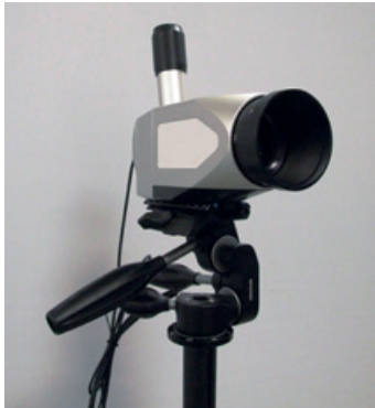
Strahldichte-Messkopf mit Okular
