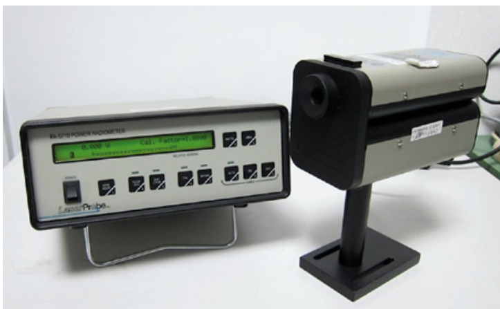
Pyroelektrischer Detektor mit Anzeige
