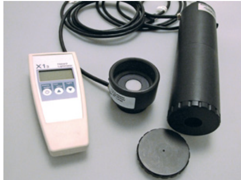
Strahldichte-Messkopf und Blende
