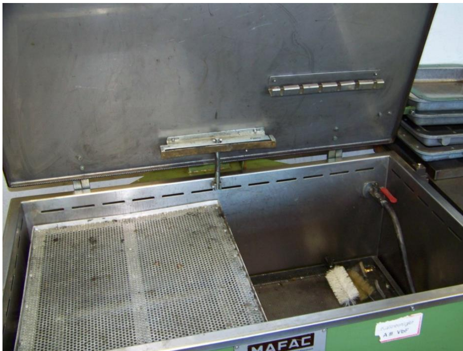
Abbildung 4: Beispiel für einen Teilewaschtisch mit Randabsaugung
