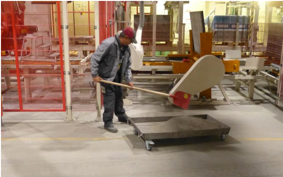
Abbildung 18: Entfernen von groben Staubteilen im Bereich eines abgesaugten Brettwenders
