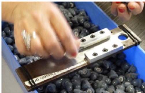
Abb. 1 Ausgewählter Ausgangsarbeitsplatz für einen Mitarbeiter mit den manuellen Teiltätigkeiten Fügen und Prüfen der Düsenelemente.
