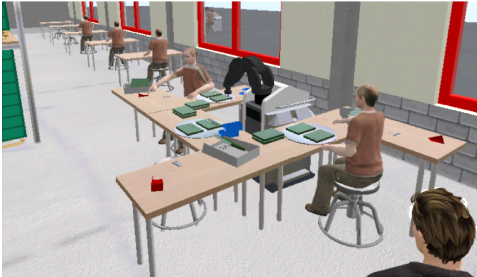
Abb. 3 Zweiter Entwurf des MRK-Arbeitsplatzes: Arbeitsplatz für bis zu 3 Mitarbeiter mit geteiltem Drehteller und der rechts im 90-Grad-Winkel angebrachten Prüfrolle.
