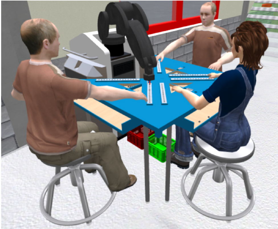
Abb. 2 Erster Entwurf des MRK-Arbeitsplatzes: Arbeitsplatz für bis zu 3 Mitarbeiter mit V-förmig angeordneten Leisten für die Düsenbestückung.
