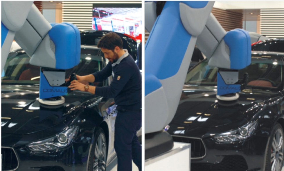
Abb. 9 Die neuen »Aura«-Roboter können Bearbeitungsaufgaben automatisch (links) oder in direkter physischer Interaktion mit dem Mensch ausführen (rechts).
