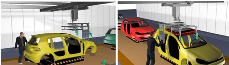
Abb. 5 Koter kann automatisch ein Panoramadach von einer Klebstation abholen (links), sich in vorderen Rahmen zentrieren (mit Hilfe von Kraft/Nachgiebigkeitsregelung) und kooperativ mit Mensch das Dach montieren (unterstützt durch eine virtuelle Führung in Form einer abgeschnittenen quadratischen Pyramide – rechts).
