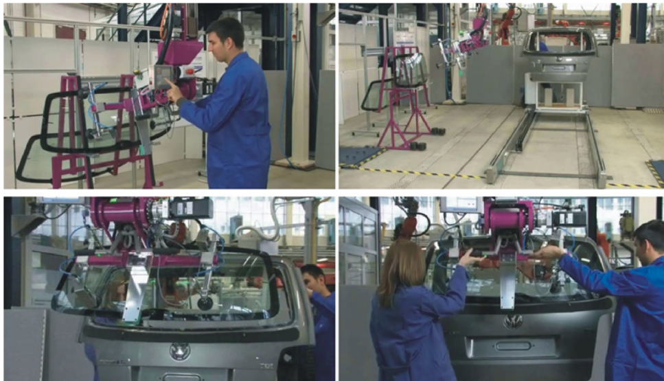
Abb. 3 PISA-Koboter-Demonstrator am Fraunhofer IPK für die halbautomatische Windschutzscheibenmontage (VW-Touran): Walk-Through. Programmierung (oben links), automatisierte Windschutzscheiben-Aufnahme (oben rechts) und die Positionierung in der Nähe der beweglichen Karosserie (unten links) sowie abschließende interaktive Mensch-Koboter-Mensch-Montage (unten rechts).
