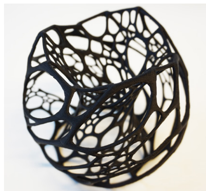
Abb. 1 Mittels additiver Fertigung erzeugter Lampenschirm (Design: nervous-system auf www.thingiverse.com )
