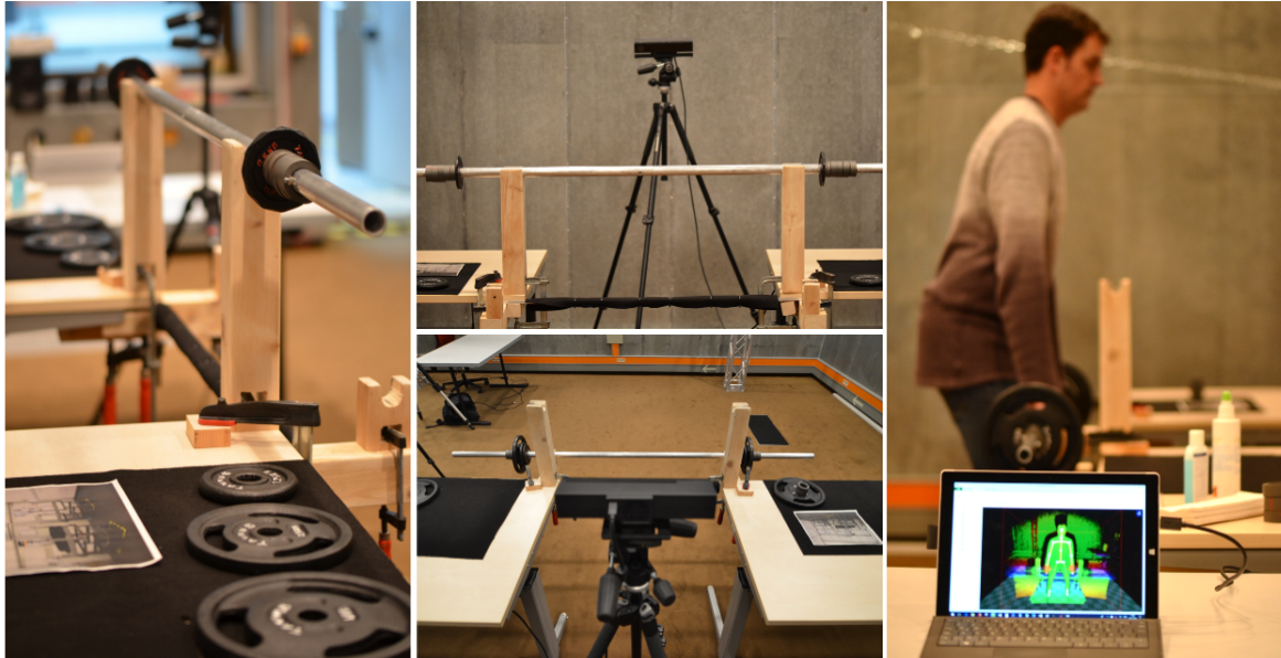
Abb. 20 Versuchsaufbau Heben Arbeitsfläche, Arbeitsfläche oben
