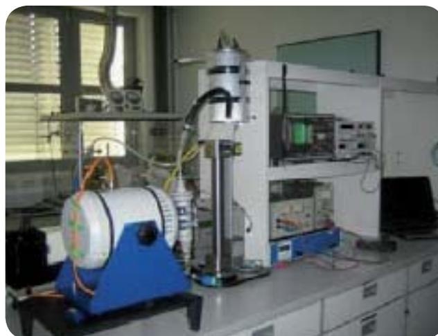
Abbildung 3: Prüfstandtest zur Beurteilung des Staubungsverhaltens von Nanomaterialien („Shaker-Verfahren“)
