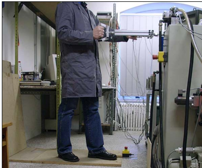
Abb. 3.12 Haltung der Versuchspersonen am Zweihandimpedanz-Versuchsstand
