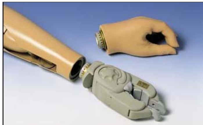
Abb. 1.20 DMC-Elektrogreifer der Myoelektrischen Handprothese nach [54]
