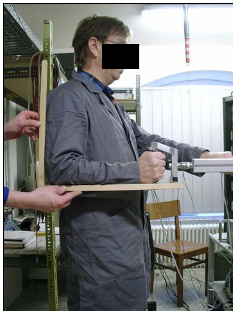
Abb. 3.17 Kontrolle des Armbeugewinkels des rechten HAS
