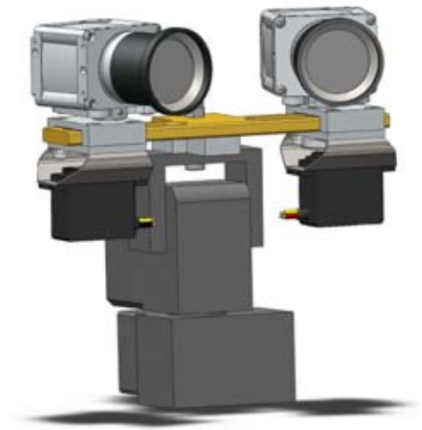
Abb. 6.3 CAD-Modell des Stereokamerasystems bestehend aus Schwenk- und Neigeeinheit, Kameraträger und servobasierter Vorrichtung zur Vergenzsteuerung der Kameras
