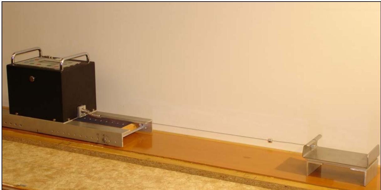
Abb. 8.2 Gleitreibungsmessgerät für die Stufenkantenprüfung auf der Basis des GMG 100
