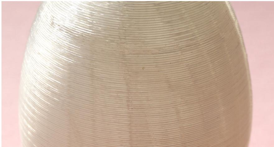
**Abb. 2.1** Treppenstufeneffekt bei einer Schichtdicke von 0,2 mm
