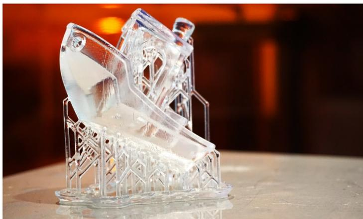
**Abb. 2.4** Mittels Stützstrukturen auf der Bauplattform verankertes Modell
