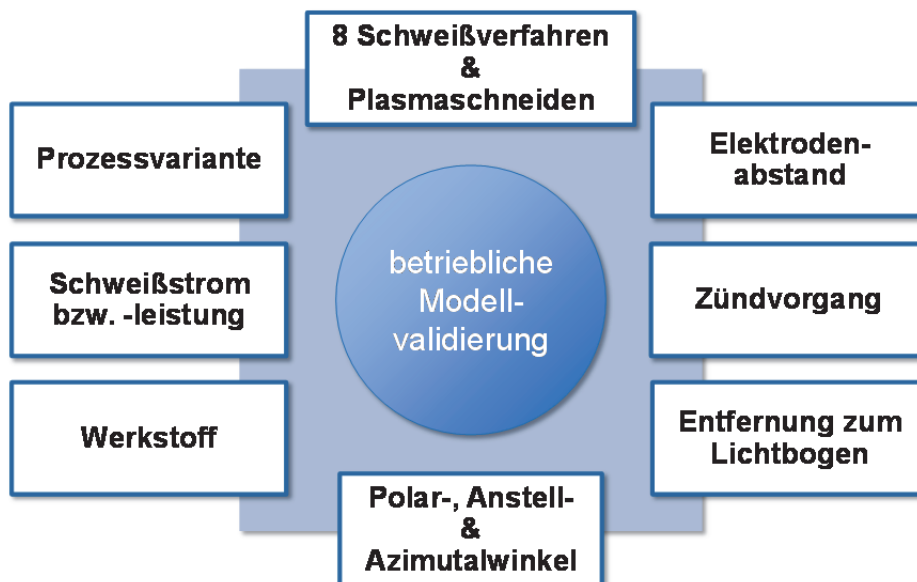
Abb. 2.2 Messplanskizze zum Teilprojekt F 2368 mit den grundlegenden Untersuchungsvorhaben bzw. Parametervariationen. Ein Teil davon soll abschließend in der betrieblichen Praxis überprüft werden.
