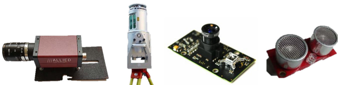
Abb. 2.1 Sensoren: Industriekamera, 3D-Laserscanner, 3D-Kamera, Ultraschallsensor (von links nach rechts).
