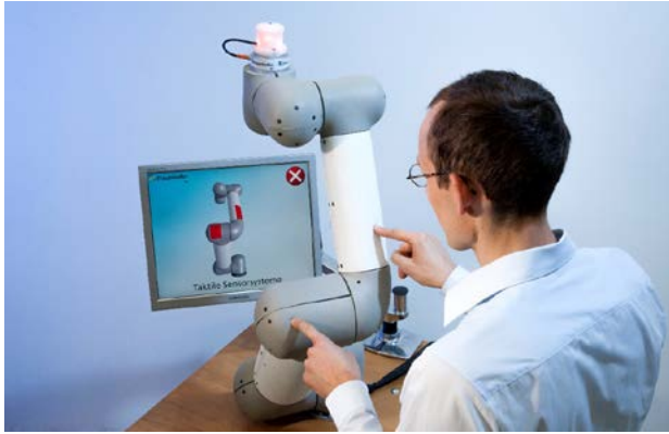
Abb. 2.5 Lokalisierung der Druckeinwirkung an einem Roboter (SCHENK 2016). Bildquelle: Fraunhofer IFF.
