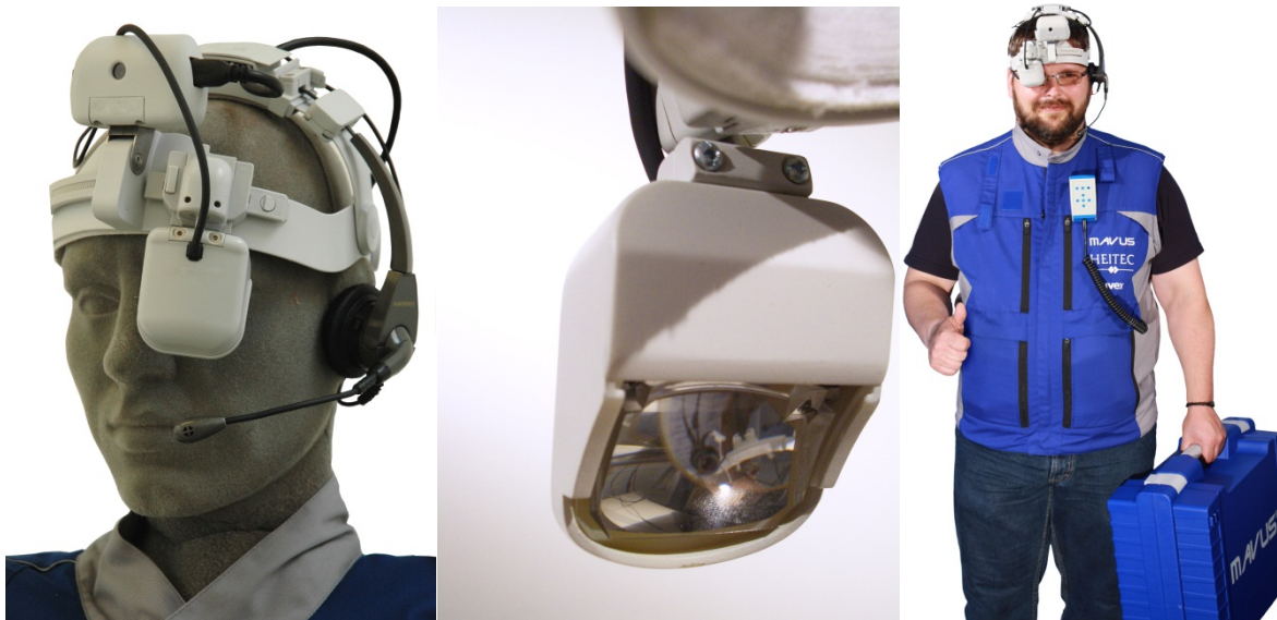
Abb. 2.2 Das verwendete MAVUS® 1 -HMD-System. Links: Der Kopfträger mit Display, Kamera, Headset. Mitte: Das Display in Nahaufnahme. Rechts: Das Komplettsystem inklusive Weste und Tragekoffer.
