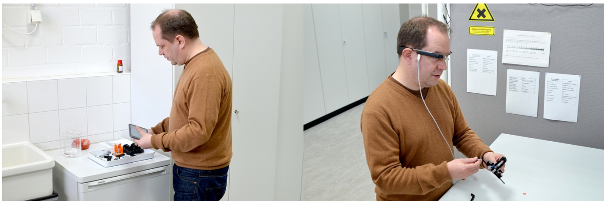
Abb. 4.4 Links: Aufnahme der Lego-Technic-Bausteine an einem Ort (hier mit Tablet-PC). Rechts: Zusammenbau des Fahrzeuges an einem vier Meter entfernten Ort (hier exemplarisch mit Google Glass, inkl. Akkuerweiterung).
