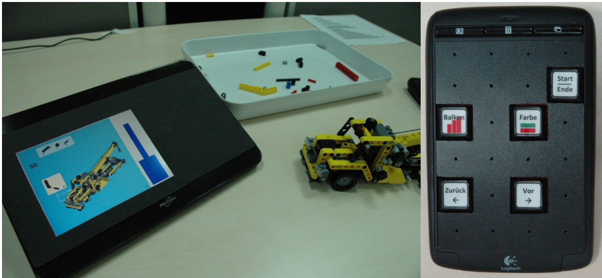
Abb. 2.3 Links: Der Tablet-PC Motion CL900 mit abgeklebter Darstellungsfläche von 800x600 Pixeln und Legoanleitung. Rechts: Das umgebaute Nummernpad mit Reaktionstasten für die Monitoringaufgabe (oben/Mitte) und Tasten zum vor- und zurückschalten der Aufbaufolien.
