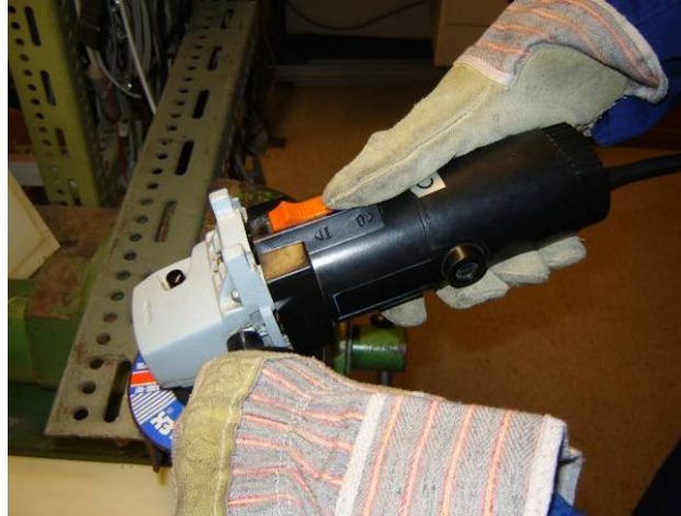
Abb. 5.32 Winkelschleifer mit Maschinenkörperdurchmesser 63 mm
