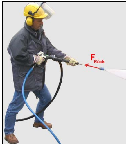
Abb. 6.1 Rückstoßkraft F_{\text{Rück}} beim Hochdruckreiniger
