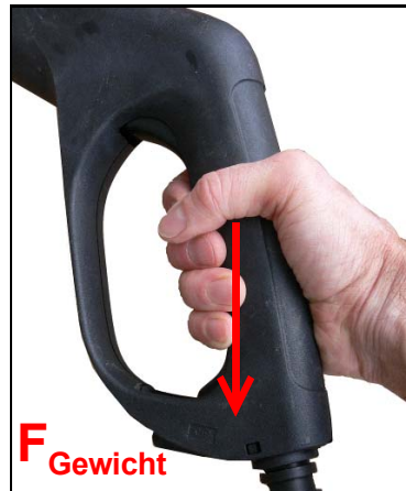
Abb. 6.2 Gewichtskraft F_{\text{Gewicht}} beim Hochdruckreiniger
