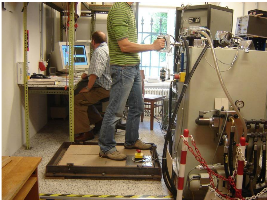
Abb. 5.33 Versuchsstand (Hand-Arm-Schwingungssimulator mit Griff und Andruckkraft-Messplattform)
