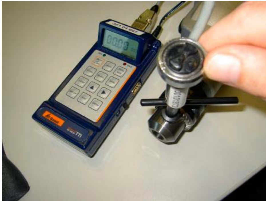
Abb. 4.56: Messung des Drehmomentes beim Öffnen des Bohrfutters
