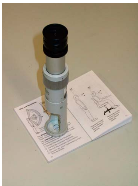
Abb. 4.54: Messung von Zeichenattributen mit der Messlupe
