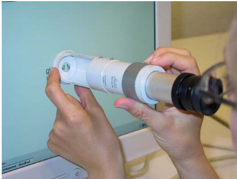
Abb. 4.51: Messung von Zeichenattributen mit der Messlupe
