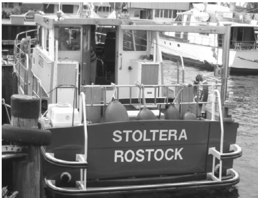
Abb. 7.6 Kleinere Einrumpf-Boote der WSP mit durchgehender Reling (Quelle: sfs)
