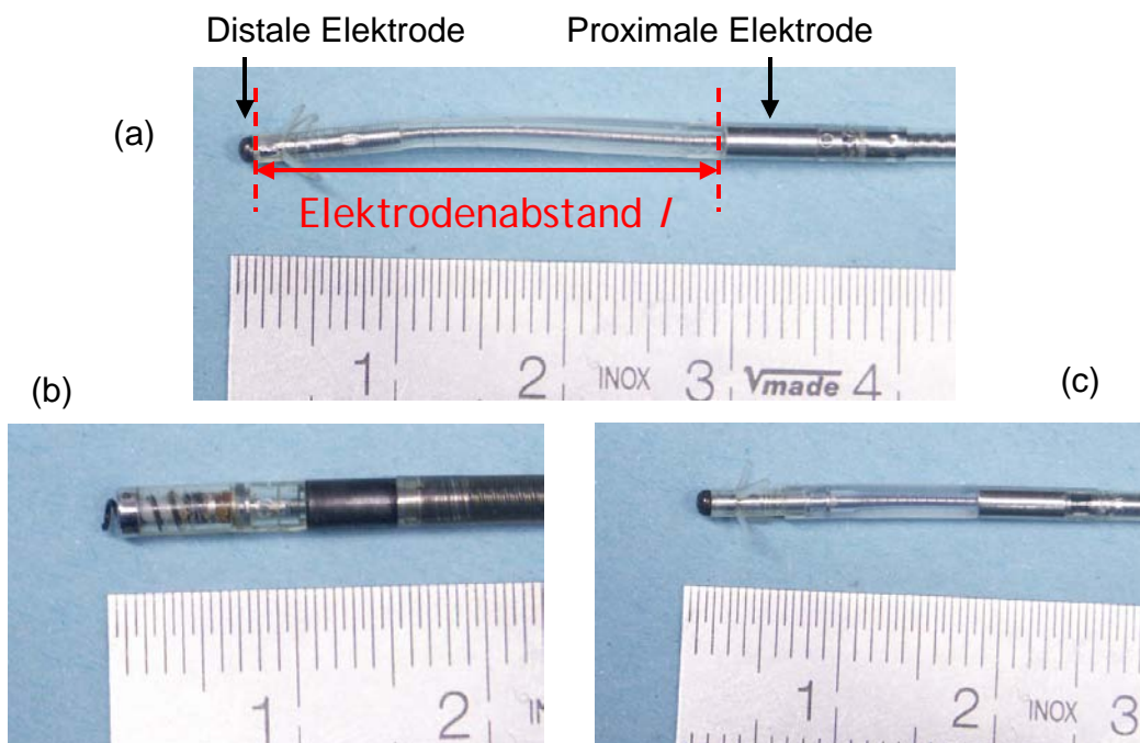
Abb. 4.9 Fotografische Darstellung von drei verschiedenen bipolaren Elektroden und Definition des Elektrodenabstandes l
