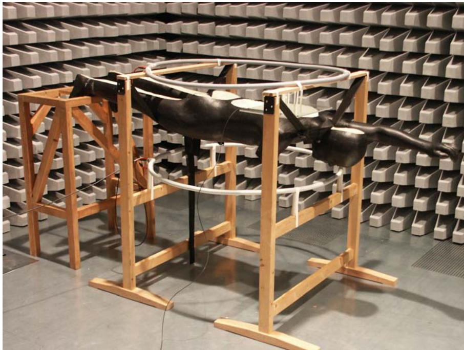
Abb. 8.10 Foto des Versuchsaufbaus mit Helmholtzspulenordnung und Ganzkörperphantom in der EMV-Absorberhalle
