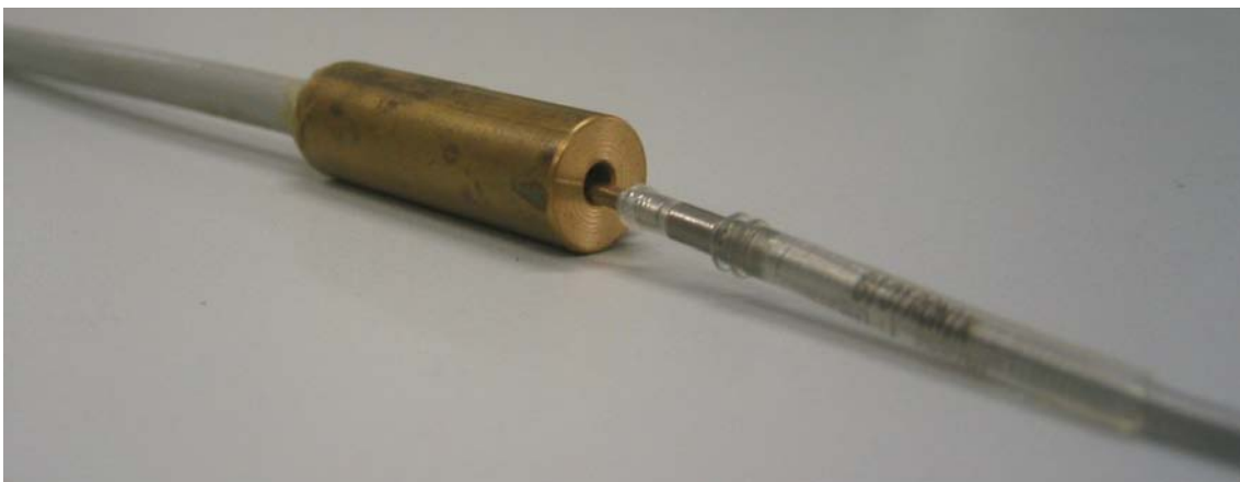
Abb. 5.6 Adapter nach IS-1 zur Verbindung von HSM-Elektrode und Messleitung
