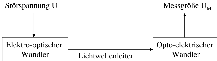
Abb. 8.2 Übertragungsstrecke aus elektro-optischem und opto-elektrischem Wandler
