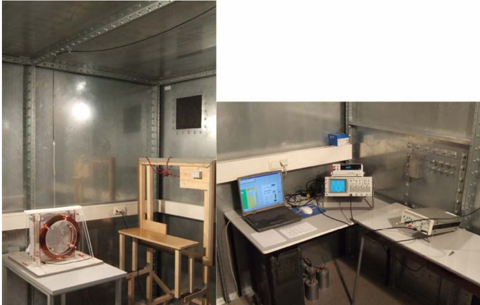
Abb. 5.7 Versuchsaufbau mit Helmholtzspule, Oszilloskop, Spannungsmesser, Messverstärker und Laptop zur Verstärkersteuerung
