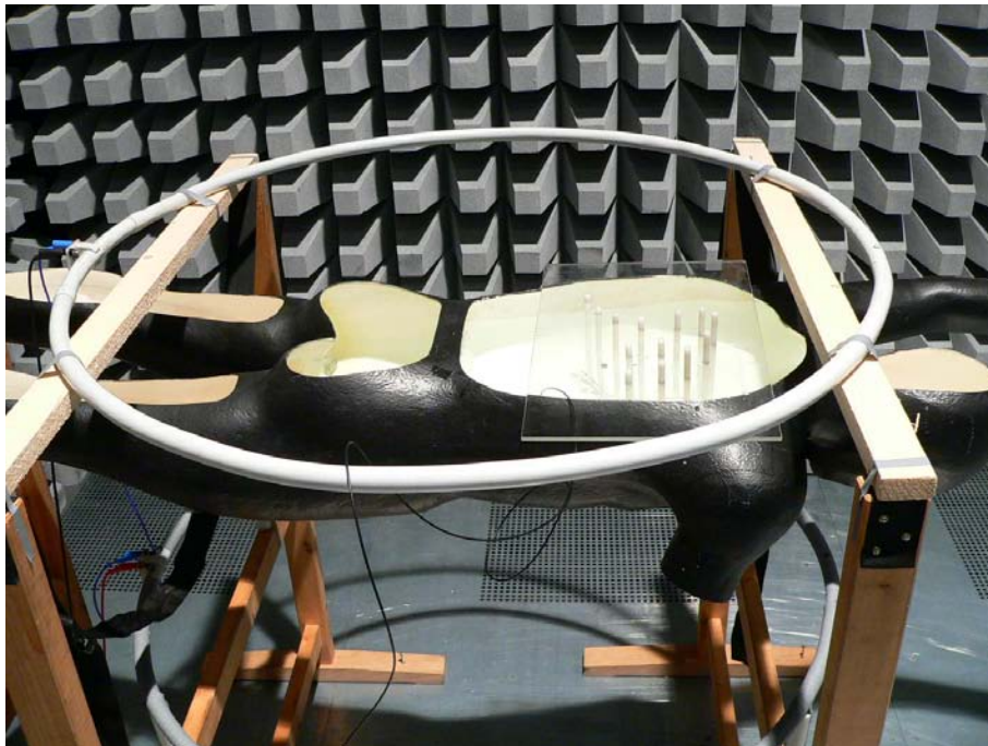
Abb. 8.12 Foto zur Darstellung der in das Ganzkörperphantom eingetauchten Herzschrittmacheranordnung
