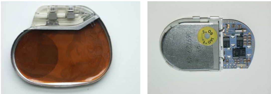
Abb. 5.1 Moderner bipolarer Herzschrittmacher nach Entfernen der metallischen Abdeckung (links) und Herzschrittmacherelektronik (rechts)
