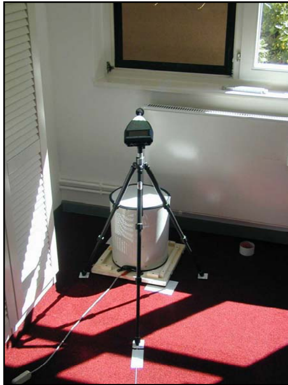
Abb. 5.4 Messaufbau mit Schallpegelanalysator und Vergleichsschallquelle
