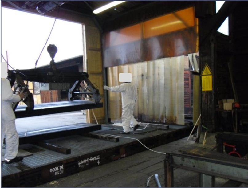
**Abb. 4.21** Verladen der Weichenschwellen mittels Kran.
