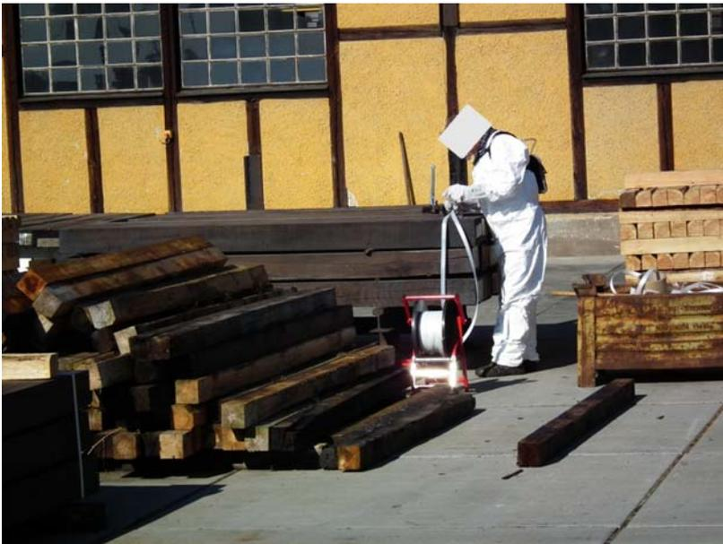
**Abb. 4.19** Paketieren von Gleisschwellen.
