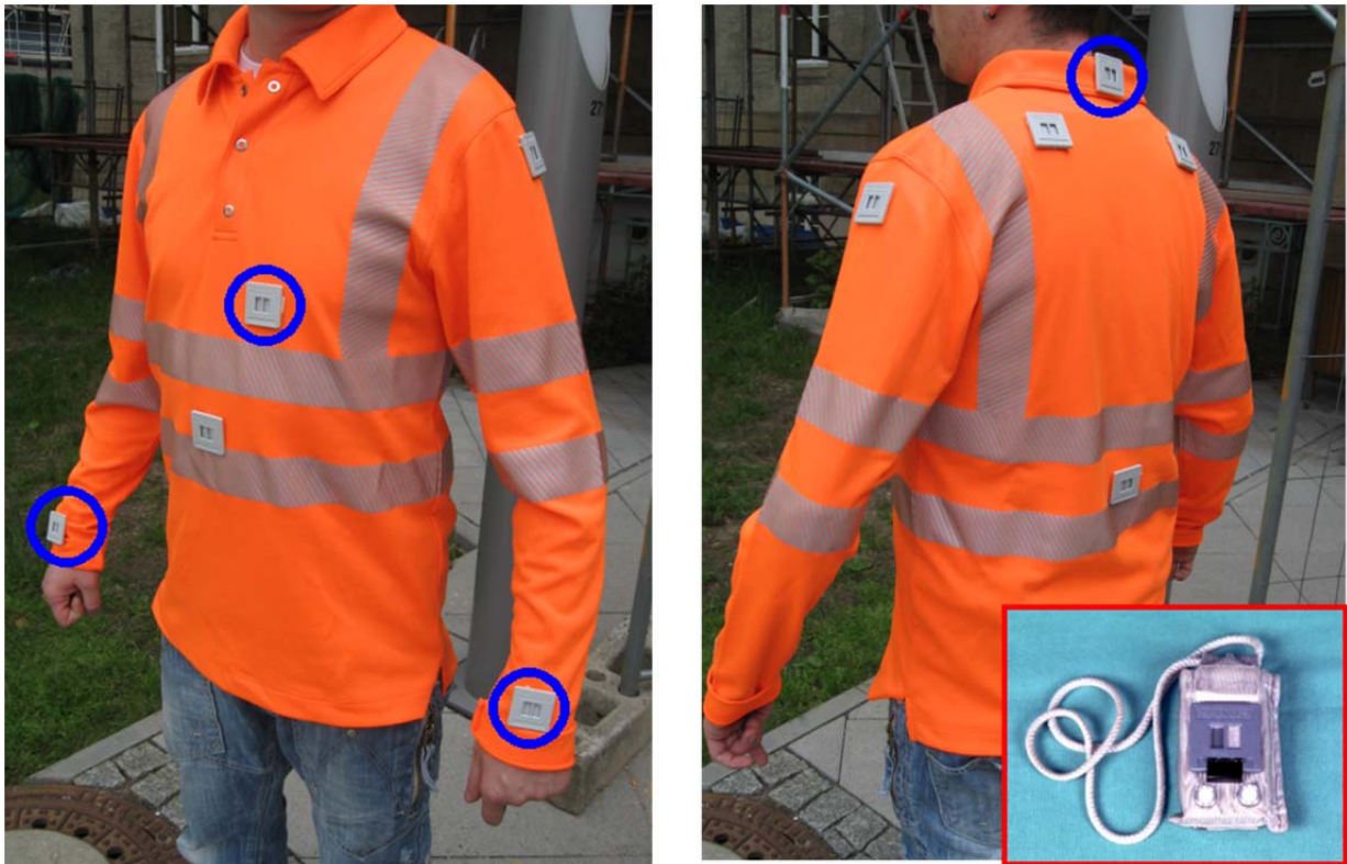
Abb. 6.5 UV-Personendosimeter-Kombination zur Messung der erythem-effektiven Bestrahlung H_{er} am Arbeitsplatz mit zeitaufgelöst messendem Datenlogger-Dosimeter X2000-4 und kumulativ messenden Polysulfonfilm-Dosimeter
