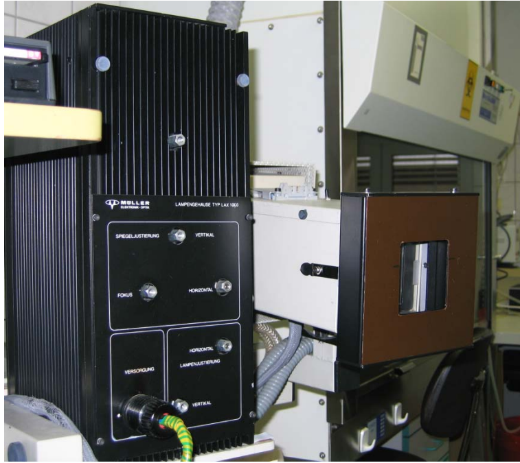
Abb. 8.3 Solarsimulatoreingang am Dermolum UM bei senkrechter Strahlungsapplikation: SSR-LT( 0^\circ ) - für großflächige Probenbestrahlung
