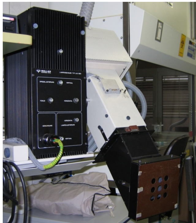
Abb. 8.4 Solarsimulatoreingang am Dermolum UM bei Strahlungsapplikation unter 45 Grad Einfallswinkel: SSR-LT( 45^\circ ) – mit Neunlochblende (je 16 mm Durchmesser) für Probandenbestrahlung
