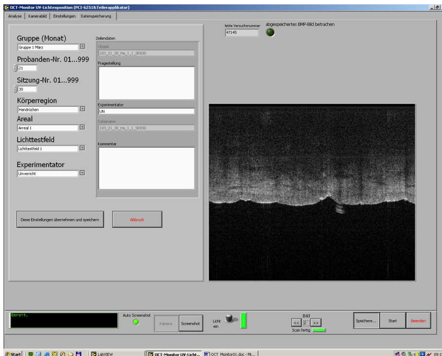
Anh. 1, Abb. 4 b Speichermodul für OCT-Aufnahmen zur Generierung von Dateinamen, die das OCT-Bild vollständig charakterisieren: Studie/Untersuchungsmonat/Probanden-Nr./Sitzungs-Nr. im Monat/ Körperregion/Areal in Körperregion/Lichttest-Feld
