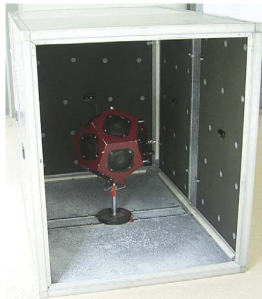
Abb. 2.2 Modellmaschine einseitig offen – gerichtete Abstrahlung
