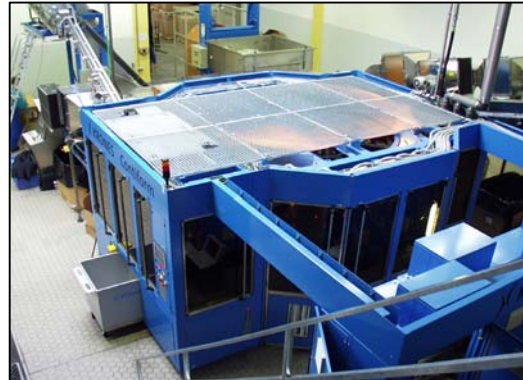
Deckfläche mit begehbarem Rost (Abstrahlung somit vorwiegend nach oben)
