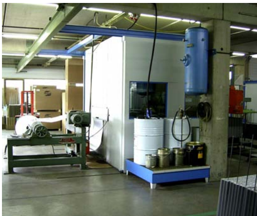
Abb. 3.6 Lamellenstanzmaschine, Einzug des Rohmaterials
