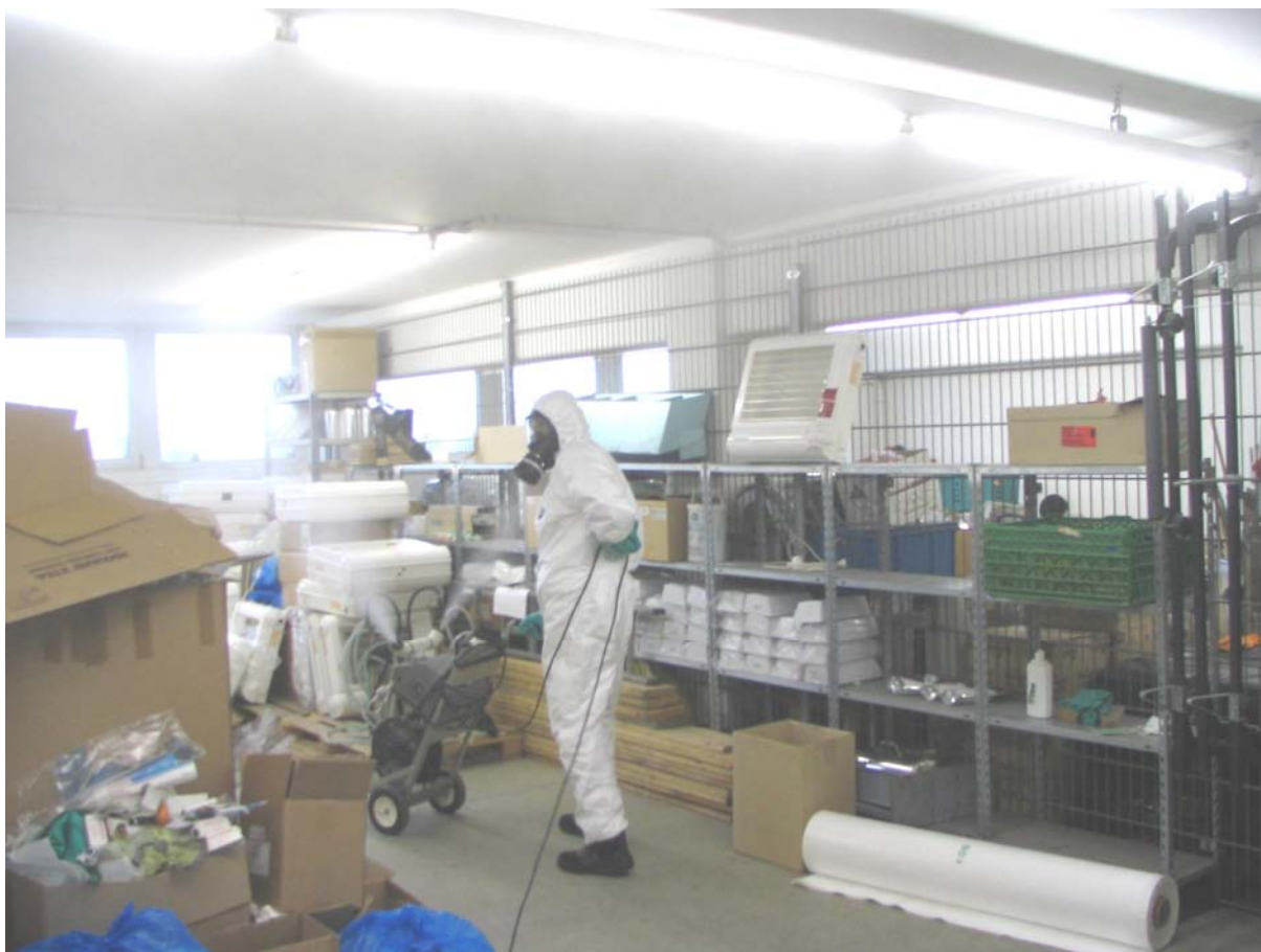
Abb. 6.8 Ausbringung eines Kaltnebelmittels mit einem ULV-Gerät
