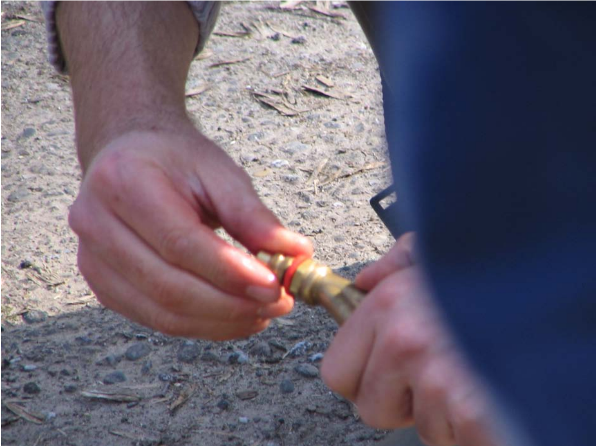
Abb. 6.5 Reinigen des Düsenkopfes bei der Ausbringung mittels Rückenspritze
