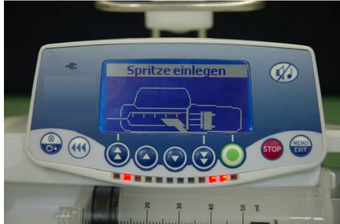
Abb. 2.14 Spritzenpumpe C – Optische Signale
