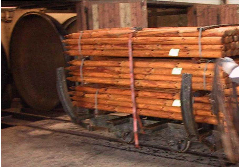
Abb. 6.1 Entleerung eines Kessels
