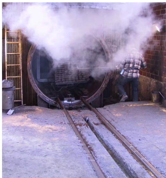
Abb. 6.2 Öffnen des Kessels bei der Teerölimprägnierung
