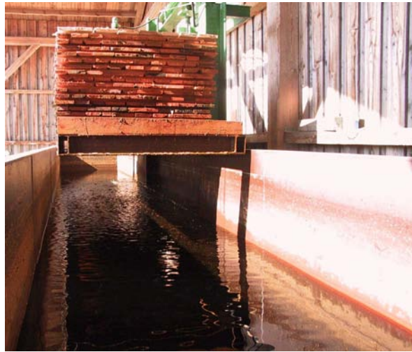
Abb. 6.10 Einfahren des Holzes in die Anlage zur Trogränkung
