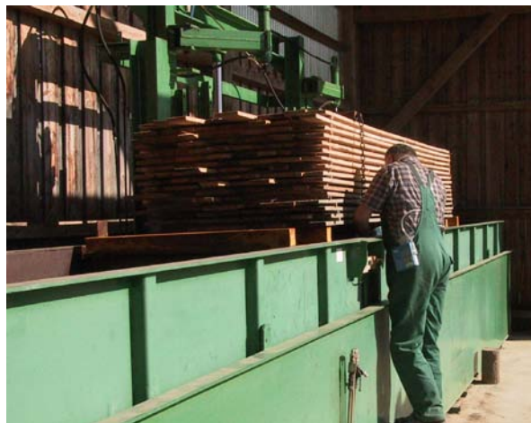
Abb. 6.9 Beladen der Anlage zur Trogränkung
