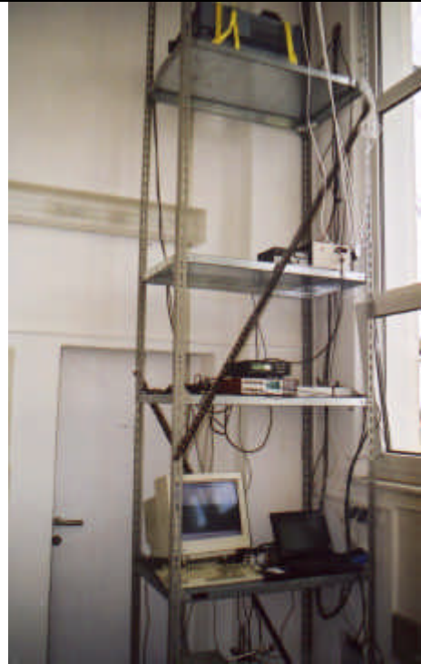
Abb. 3.1 b Spektroradiometer im klimatisierten Raum unter Messkopfräger
