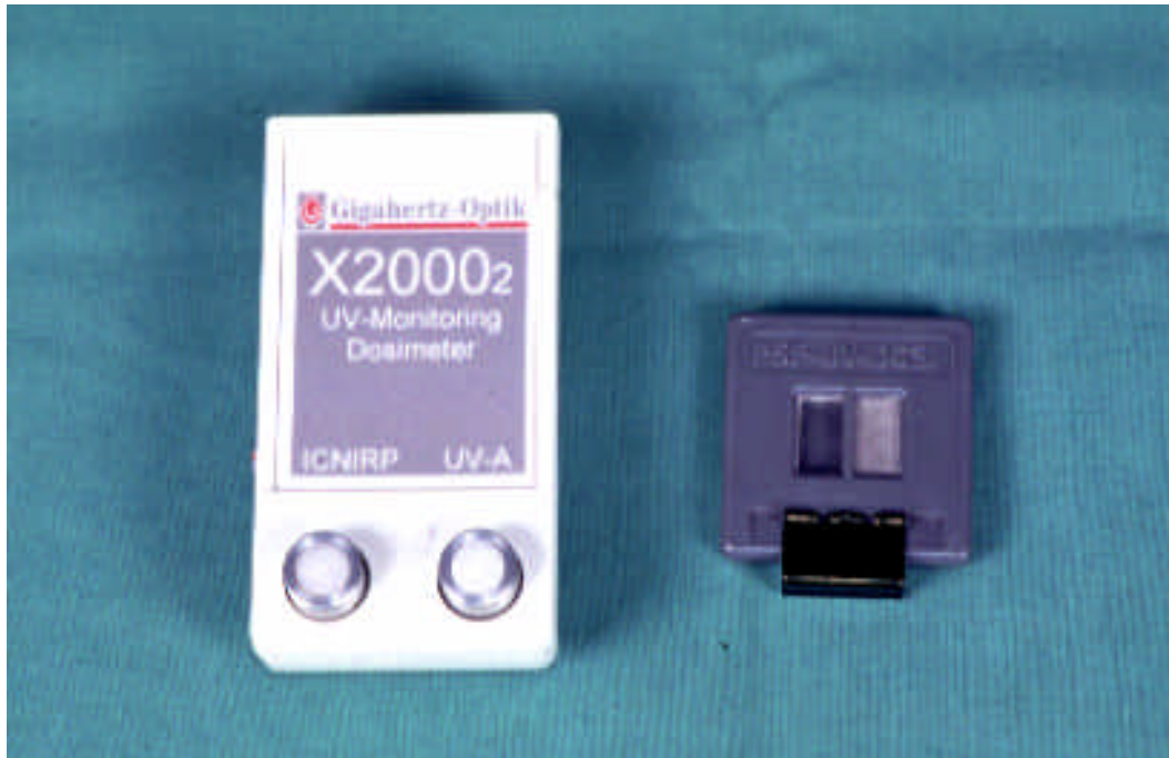
Abb. 3.2 a Datenlogger-UV-Dosimeter X2000 und PSF-UV-Dosimeter
