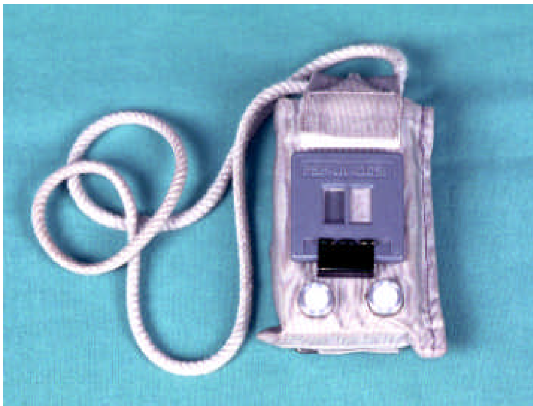
Abb. 3.2 b X2000 und PSF-Dosimeter in Tragetasche zur simultanen Messung der UV-Personendosis
