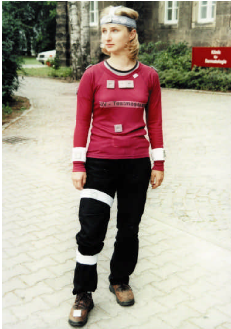
Abb. 3.4 Set zur Messung der UV-Körperverteilung unter Alltagsbedingungen an 19 Positionen (Anmerkung: in Brustposition ein Dosimeter; Messungen unter Schulterblatt nicht durchgeführt)
