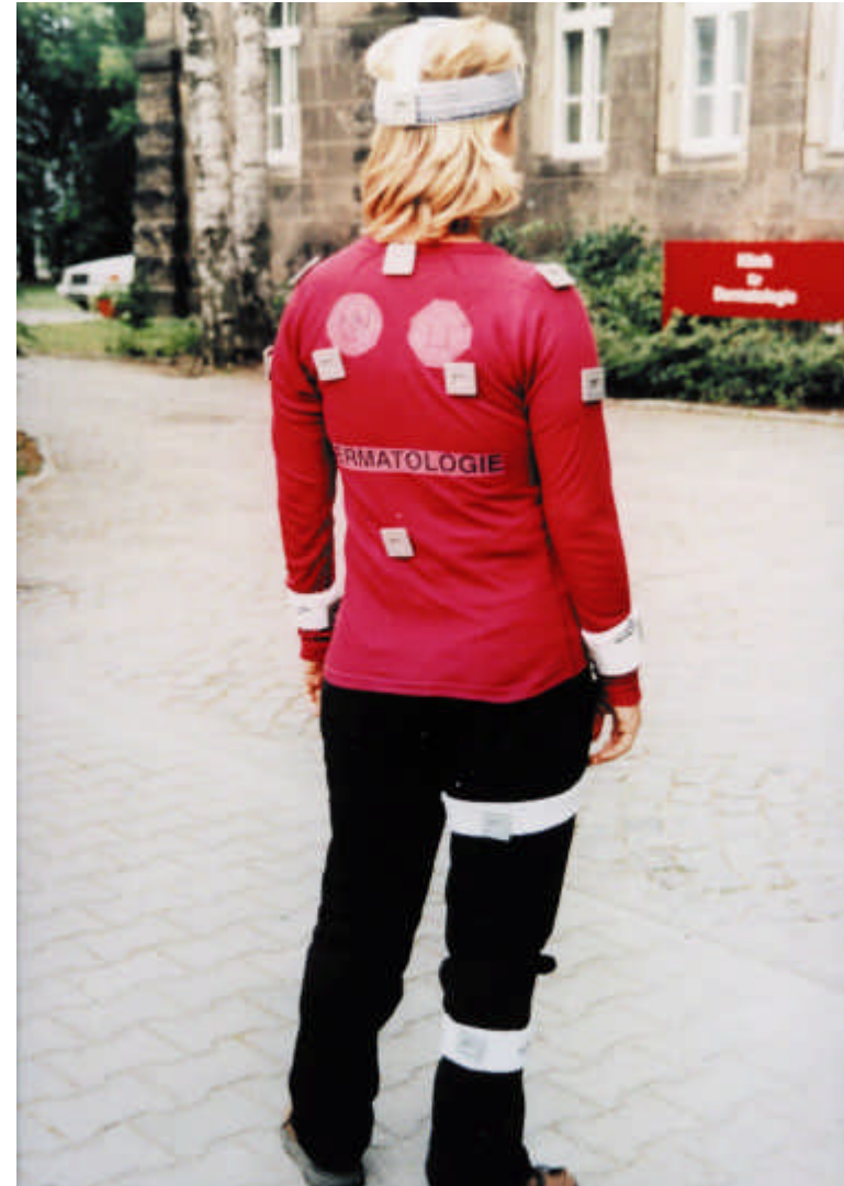
Abb. 3.4 Set zur Messung der UV-Körperverteilung unter Alltagsbedingungen an 19 Positionen (Anmerkung: in Brustposition ein Dosimeter; Messungen unter Schulterblatt nicht durchgeführt)
