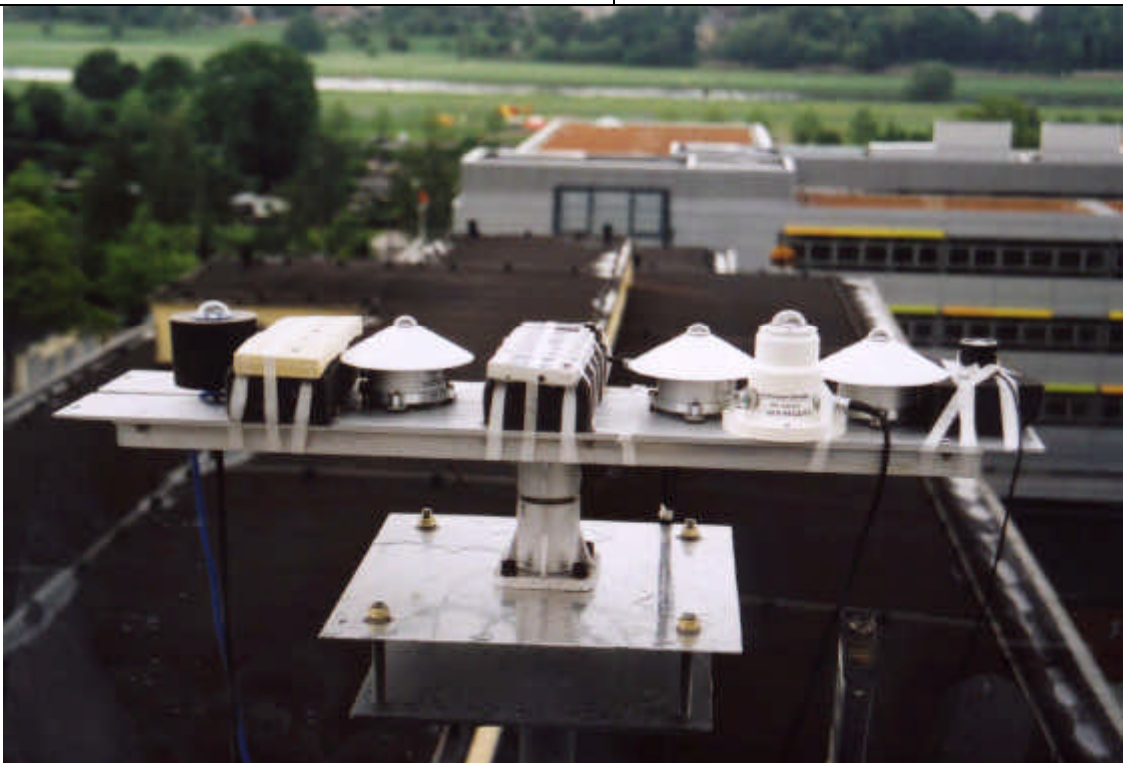
Abb. 3.1 c Spektroradiometer-Messkopf und ICNIRP-, UV-A-, Ery-Breitband-Messkopf für solare UV-Globalstrahlungsmessung sowie elektronische UV-Personendosimeter zur Interkalibrierung
