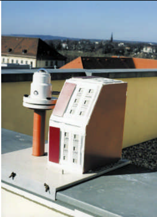
Abb. 3.1 a Robertson-Berger-Meter und Polysulfonfilm-Dosimeter zur Messung der Globalstrahlung
