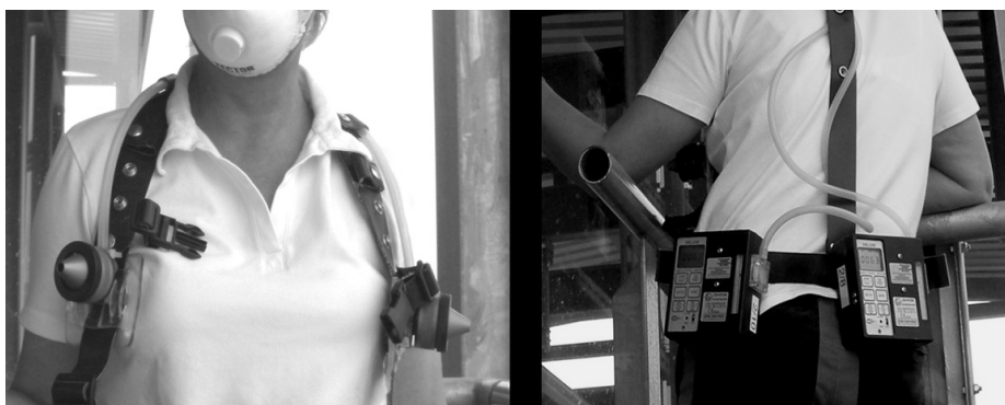
Bild 1. Einsatz des personengetragenen Sammelsystems, bestehend aus Probenahmekopf (links) und tragbaren Pumpen (rechts).
