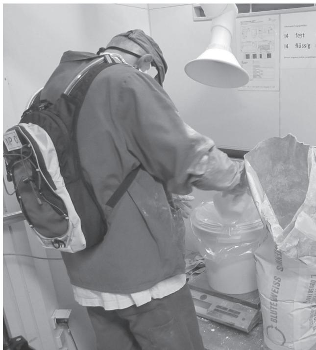
**Bild 2.** Manuelle Abfüllung fester Stoffe mittels Handschaufel.
