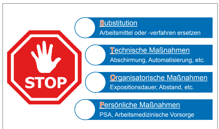
Abb. 5: Exemplarische Umsetzung des STOP-Prinzips beim Schweißen
